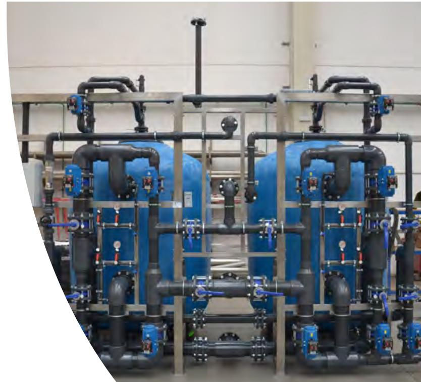
Se denomina así a la filtración que se realiza dentro de una zona de porosidad comprendida entre  $0,1 \mu\text{m}$  -  $10 \mu\text{m}$ , que permite la eliminación de sólidos en suspensión, partículas finas, coloides, algas y microorganismos, entre otros.
