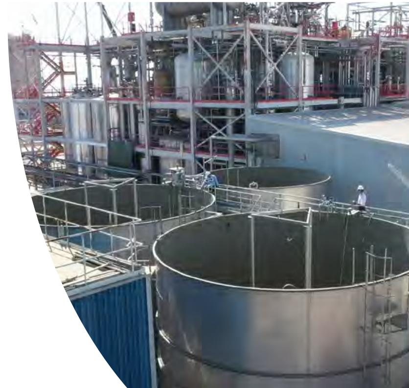
En aquellos sectores donde la carga contaminante biodegradable es muy elevada, se emplean microorganismos anaerobios. Se obtienen como subproductos biogás ( $\text{CH}_4$  y  $\text{CO}_2$  fundamentalmente) y una pequeña fracción de lodos. En ocasiones, el efluente que se obtiene no cumple con los requisitos mínimos de calidad por lo que requiere de un tratamiento adicional de afino.
