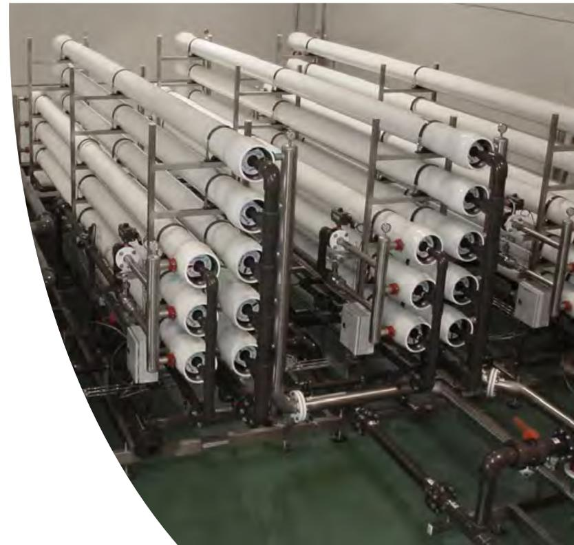
La ósmosis inversa es una tecnología de membrana que permite eliminar la salinidad del agua. Se basa en un proceso de difusión a través de una membrana semipermeable que facilita el paso de gases disueltos y moléculas sin carga electrostática de bajo peso molecular.
