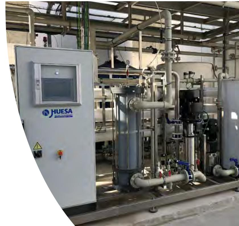
La ultrafiltración es una tecnología de membrana que tiene lugar dentro de un rango de porosidad de membrana comprendido entre 0,001 y 0,1  $\mu\text{m}$ . Se utiliza para la eliminación selectiva de materia en suspensión, partículas, macromoléculas de gran tamaño, materia coloidal o microorganismos.
